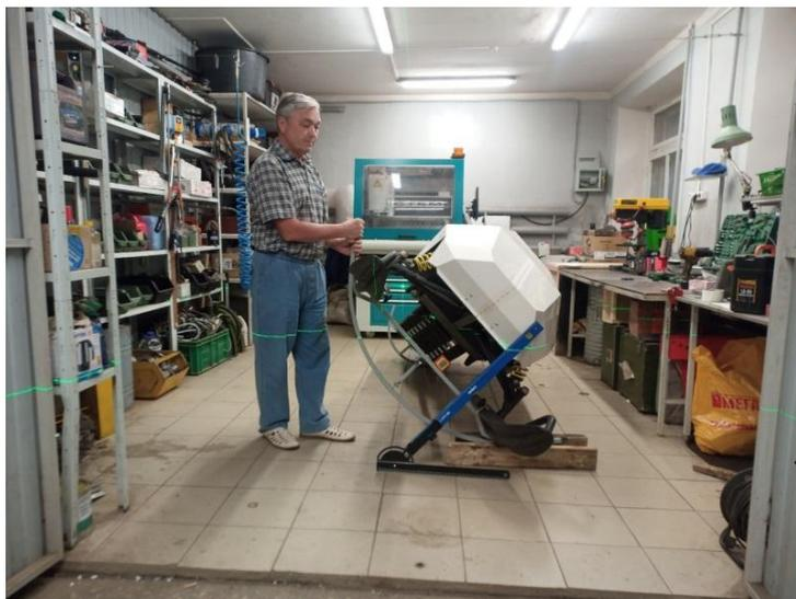
**Рис. 3. Наклонение платформы до неустойчивого равновесного положения во фронтальной плоскости**
