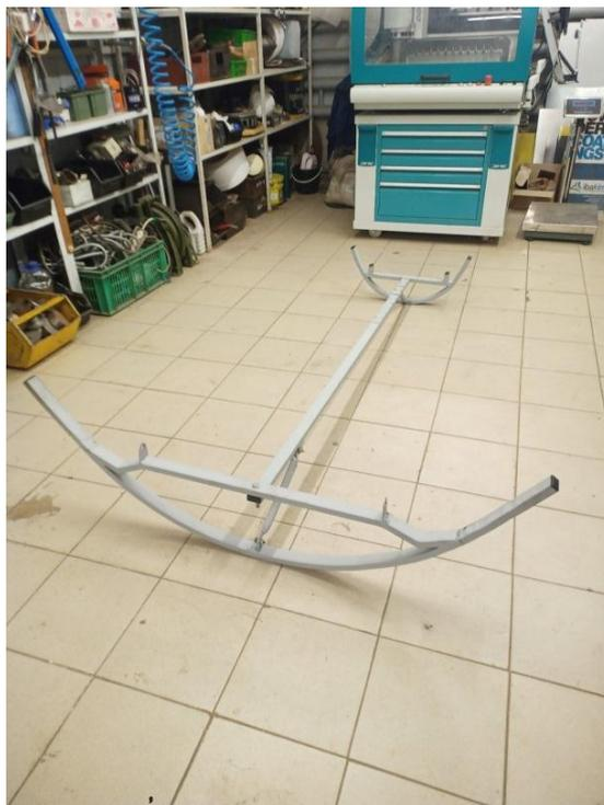
**Рис. 1.** Стенд для определения координат расположения центра тяжести платформы
