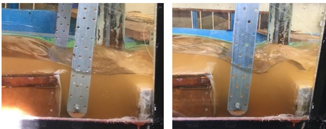
Рис. 3. Положение модели в потоке при различных расходах в лотке для случая «труба в траншее»
