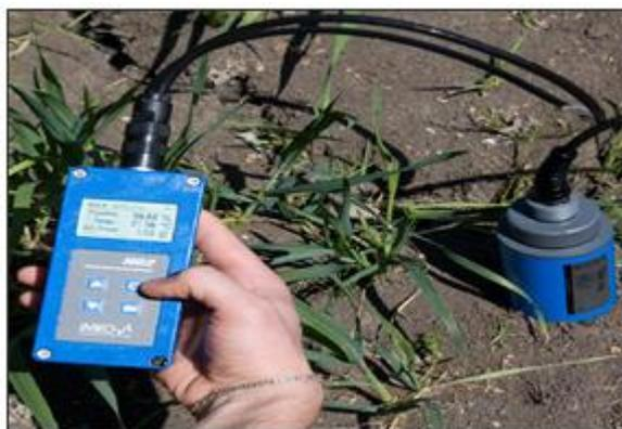
Рис. 4. Измеритель влажности почвы
