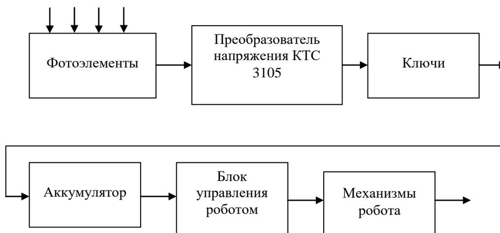
Рис. 4. Блок-схема устройства управления роботизированным объектом
