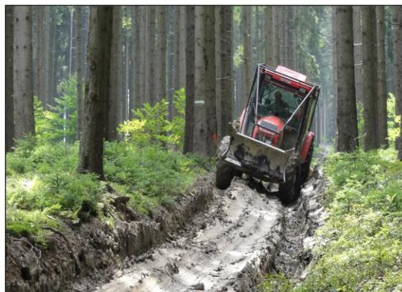
**Рис. 1. Повреждение дороги при частой проходимости лесозаготовительной техники**
