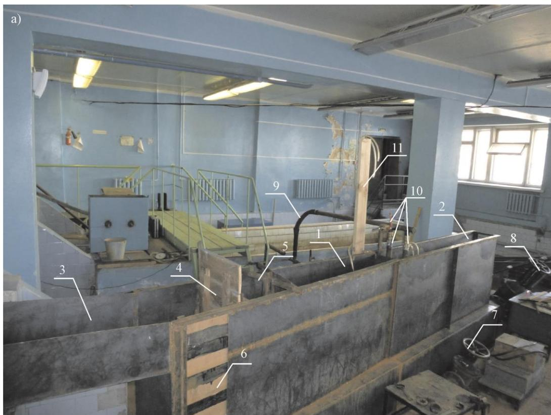
**Рис. 3. Модель гидравлического рыбозащитного устройства:** 1 – головная часть модели; 2 – выходная часть модели; 3 – входной лоток; 4 – гаситель потока; 5 – сетчатое полотно; 6 – наборный щит головной части модели; 7 – задвижка малого водовода; 8 – задвижка большого водовода; 9 – напорный трубопровод системы струеобразующих насадков; 10 – шаровые краны; 11 – пьезометры
