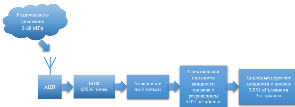
Рис. 1. Методика получения спектра помех с разрешением 3 кГц
