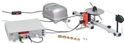
Рис.1 Лабораторная установка №15 «Вращательное движение с равномерным ускорением»
