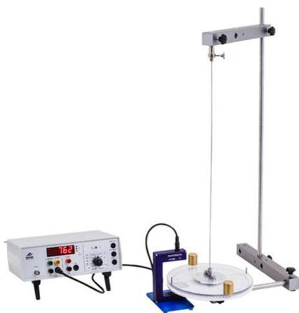
Рис.5. Лабораторная установка №24 «Исследование скручивания на цилиндрических стержнях»
