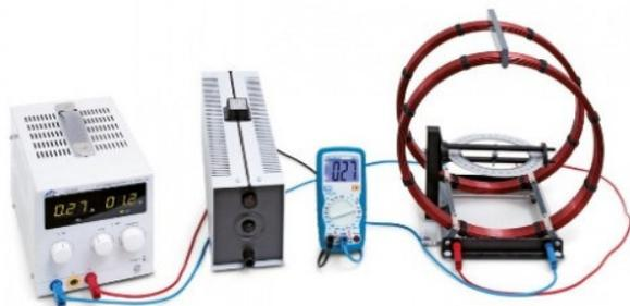
Рис.6. Лабораторная установка №13 «Магнитное поле Земли»
