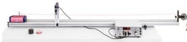
Рис.3. Лабораторная установка №9 «Равноускоренное движение»
