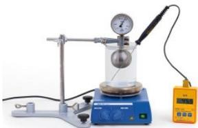
Рис.7. Лабораторная установка №27 «Закон Гей-Люссака»
