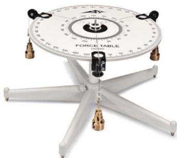
Рис.1. Лабораторная установка №7 «Параллелограмм сил»
