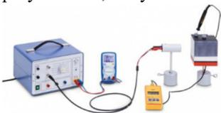
Рис.3. Лабораторная установка №36 "Куб Лесли I"
