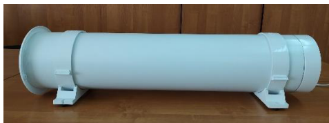
Рис. 2. Прототип фильтра воздуха на основе фотокаталитических плёнок \text{TiO}_2
