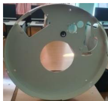
Рис. 1. Диск крышки и кольцо изготовлены из листового материала
