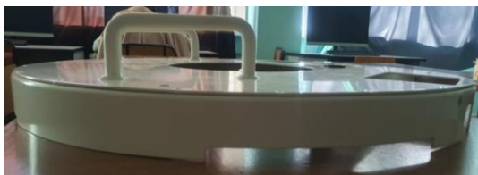
Рис. 1. Диск крышки и кольцо изготовлены из листового материала
