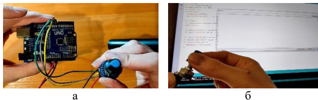
а – Внешний вид подключения энкодера к плате Arduino UNO; б – конвертация цифрового сигнала при повороте ручки энкодера Рис. 2. Подключение инкрементного энкодера ACELEX к плате Arduino UNO
