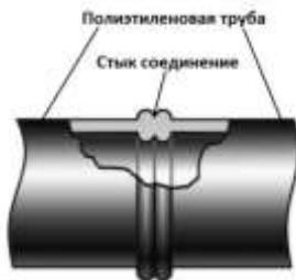
Рис. 1. Соединение полиэтиленовых труб встык
