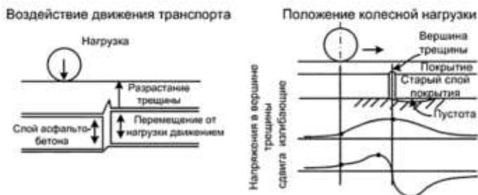
Механизм отраженного трещинообразования
