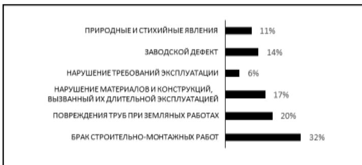
Рис. 2. Причины нарушения соединения полиэтиленовых газопроводов
