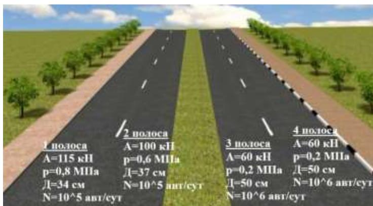
Рис. 1. Параметры расчетной нагрузки для четырех полос движения
