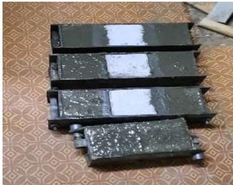
Рис. 2. Опытные образцы с вкладышем из газобетона
