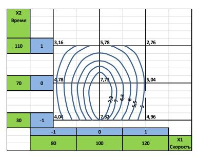
Графическая модель влияния скорости и времени на износ дорожного покрытия из порфирита
