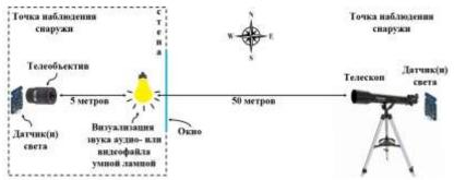
Рис. 1. Экспериментальная установка для скрытого съема аудиовидеоинформации
