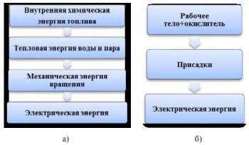
Рис. 2. Принципиальная схема преобразования энергии: а – паросиловые; б – магнитогидродинамические
