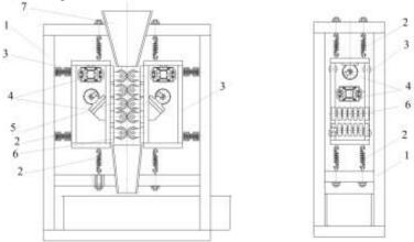
Установка для отделения бересты от луба: 1 – станина, 2 – пружины, 3 – корпуса, 4 – вибратор, 5 – роликовые опоры, 6 – свободно вращающиеся ролики, 7 – приемный бункер
