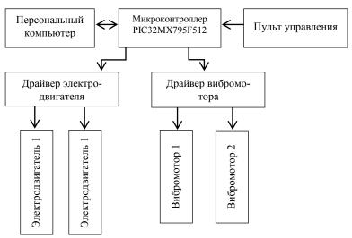
Структурная схема системы управления кресло-платформы для тренажера операторов подвижных объектов
