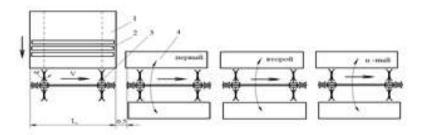
Рис. 2. Схема работы транспортера: 1 – приемная площадка; 2 – сортименты; 3 – секция транспортера; 4 – карман-накопитель
