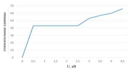
График зависимости интенсивности спектральных линий искрового разряда при подгонке толстопленочных рутениевых резисторов от разрядного напряжения
