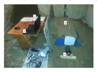
Экспериментальная установка: 1 – персональный компьютер, 2 – АЦП-ЦАП, 3 – акустический излучатель, 4 – пьезоэлектрический датчик KD-35
