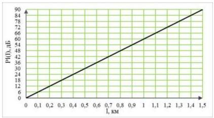
График зависимости энергетических потер из-за погодных условий (при густом тумане) на трассе от 0 до 1500 м
