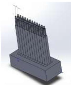
Сборная конструкция формообразующих элементов пресс-формы
