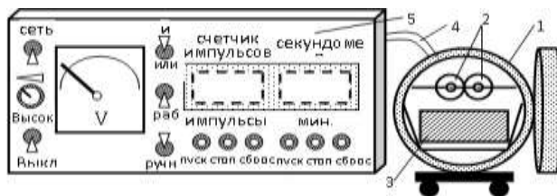
Рис. 1. Схема установки: 1 – свинцовый домик, 2 – счетчики Гейгера-Мюллера, 3 – кювета с радиоактивным веществом, 4 – соединительный кабель, 5 – измерительный блок
