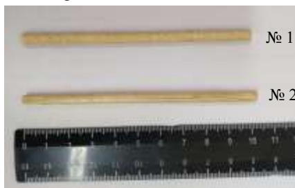
Рис. 2. Образцы для испытаний: №1 – поперек волокон; №2 – вдоль волокон
