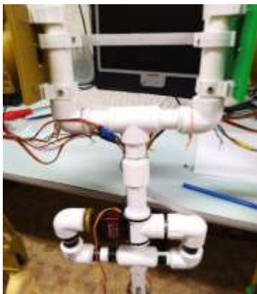
Рис. 2. Конструкция грудного и тазового отделов
