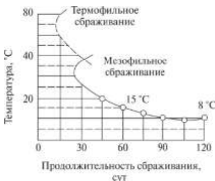
Рис. 2. Зависимость продолжительности сбраживания от температуры
