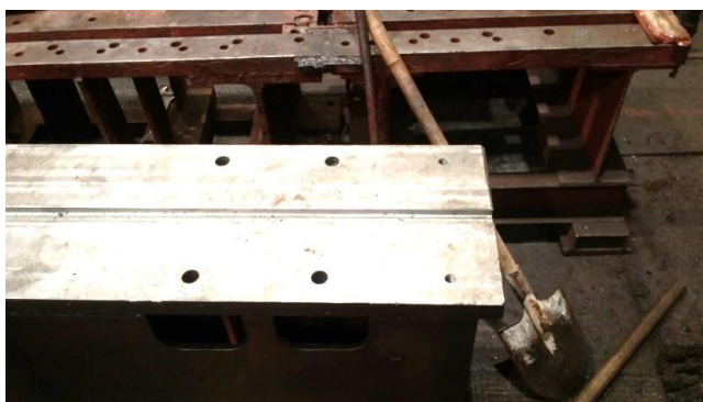
Рис. 3. Снизу – станина нового станда; сверху – старый станд
