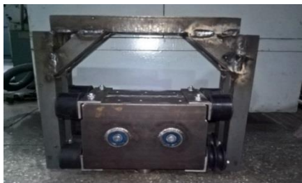
Рис. 3. Действующая модель вибропогружателя
