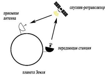
Рис. 2. Расположение спутниковой принимающей антенны на Земле, направленной на спутник-ретранслятор
