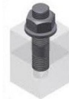
Рис. 2. Созданная трехмерная модель соединения шпилькой
