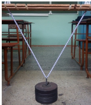
Рис. 3. Экспериментальное испытание двухстержневой системы
