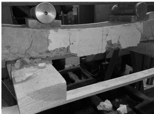
Рис. 2. Испытательный стенд с разрушенной балкой
