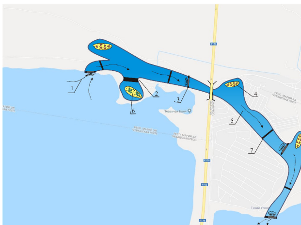
Рыбоходно-нерестовый канал в створе Чебоксарского гидроузла:
