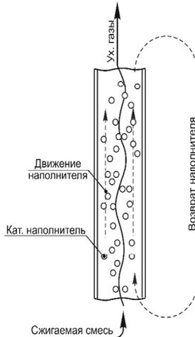
Рис. 2. Каталитическое устройство сжигания с сонаправленным движением наполнителя и сжигаемой смеси
