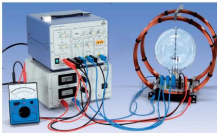
нитному полю  $B$ , под действием силы Лоренца, направление которой перпендикулярно как скорости, так и магнитному полю. В результате возникает центробежная сила, под действием которой электрон движется по круговой траектории с радиусом  $r$ , след которой мы наблюдаем.
